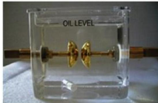
**Gambar 1. Konfigurasi elektroda berdasarkan standar IEC - 60156**
